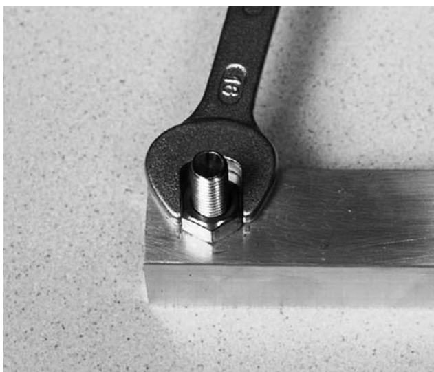
Bild 15 Se vid åtdragningen av skruvarna till att muttrarnas flank sitter i en rät vinkel i förhållande till skenornas längdsida. Detta är viktigt för kollektorns passform!
